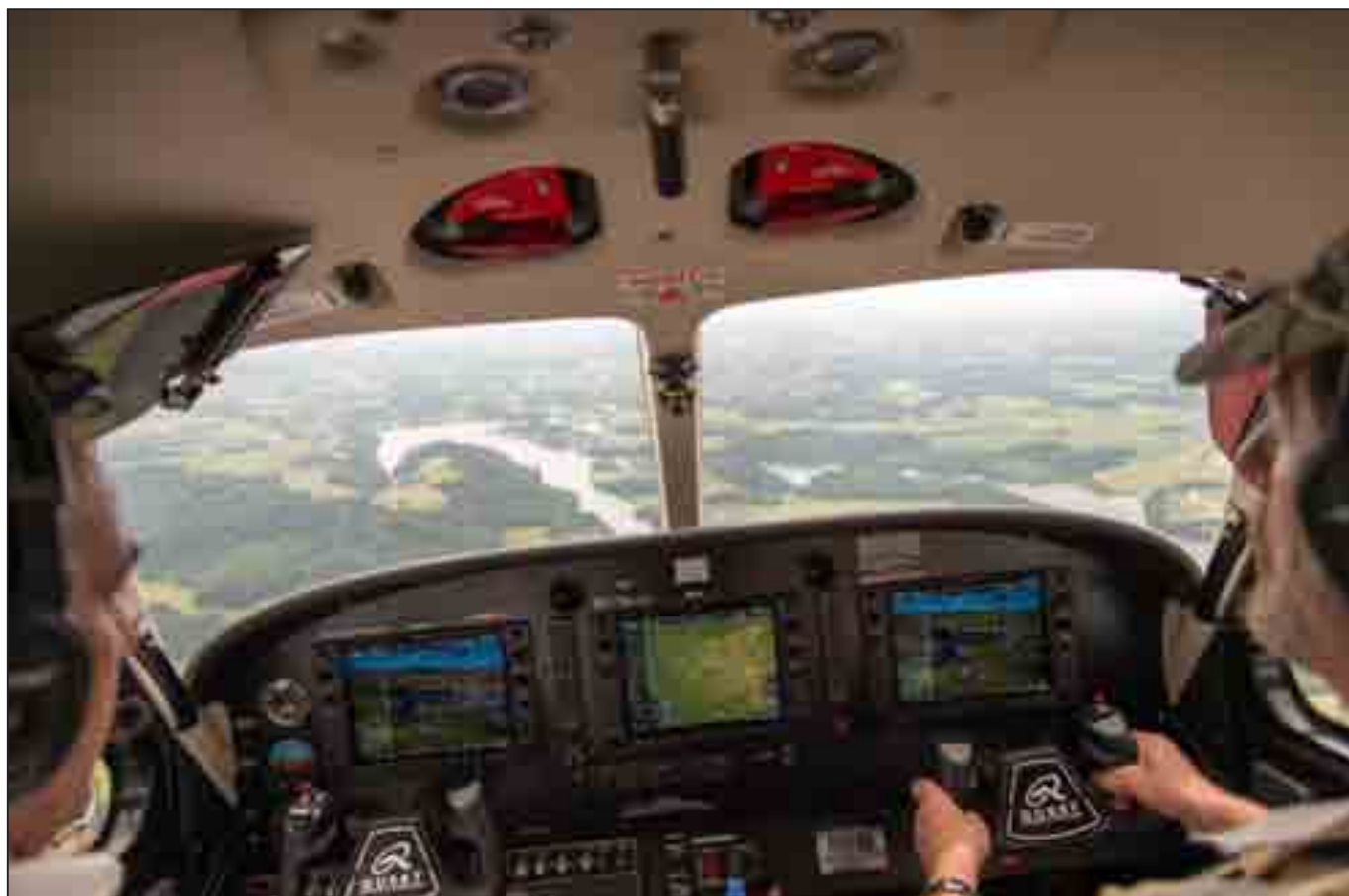
上图：三个大型多功能显示屏提供所有飞行和导航
