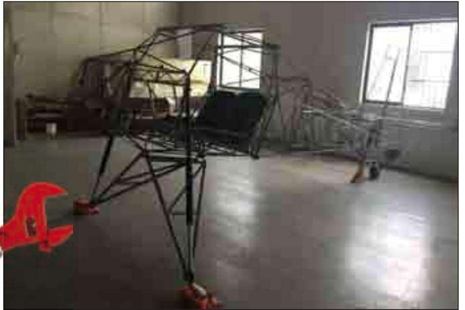
SuperSTOL 飞机机身是钢管焊接结构，结实可靠，便于制造
