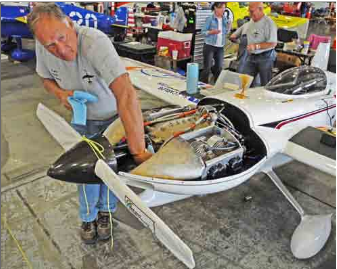
机务人员正在维护 F1 级参赛飞机” Fraed Nought “号的大陆 O-200 发动机，注意看长长的螺旋桨延长安装轴
