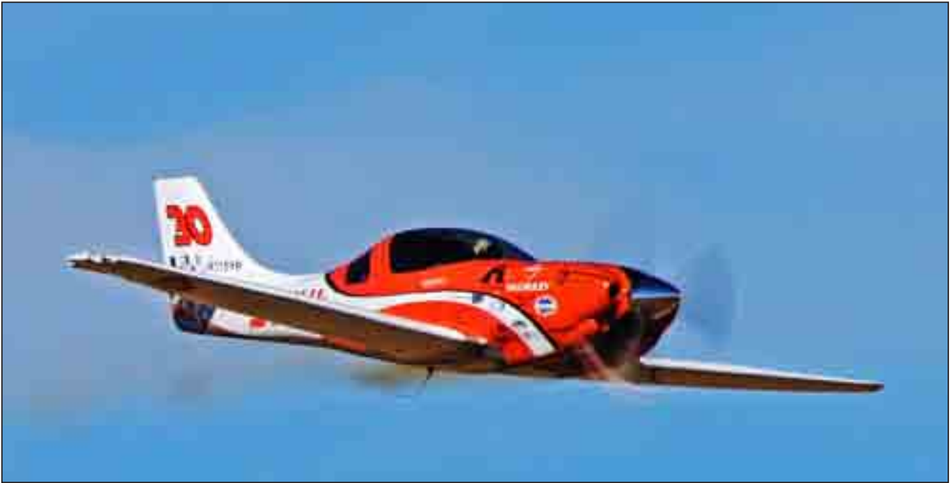
运动级的 30 号参赛机不得不退出比赛，机腹的黑烟表明这架 Lancair 实验类套材飞机的涡轮增压发动机出问题了
