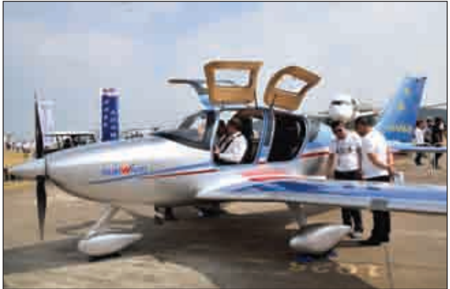
湖南山河科技公司研制的 SA160 五座新型飞机采用了碳纤维结构 的复合材料
